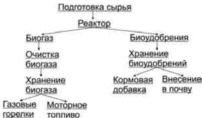
Рис.1. Схема переработки органических отходов на биогазовых установках
